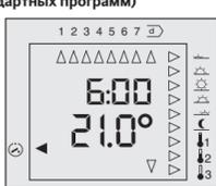
если необходимо изменить стандартные заводские установки, можно выставить значения времени для 2,4 илиб моментов переключений в течение дня. Одна из 3-х установленных температур может быть определена в соответствие каждому переключению (табл.2 или п. 2.4).
